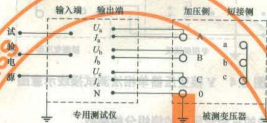
图 B.1 YN 接变压器三相法测试接线示意图
