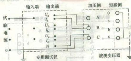
图 B.5-2 D 接变压器单相法测试接线示意图之二
