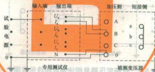
图 B.2 YN 接变压器单相法测试接线示意图
